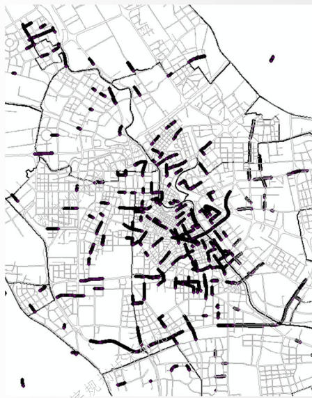
就PNG图片按照坐标位置自动拼接成整体, 并开展数字化工作, 形成一整天的拥堵数据
