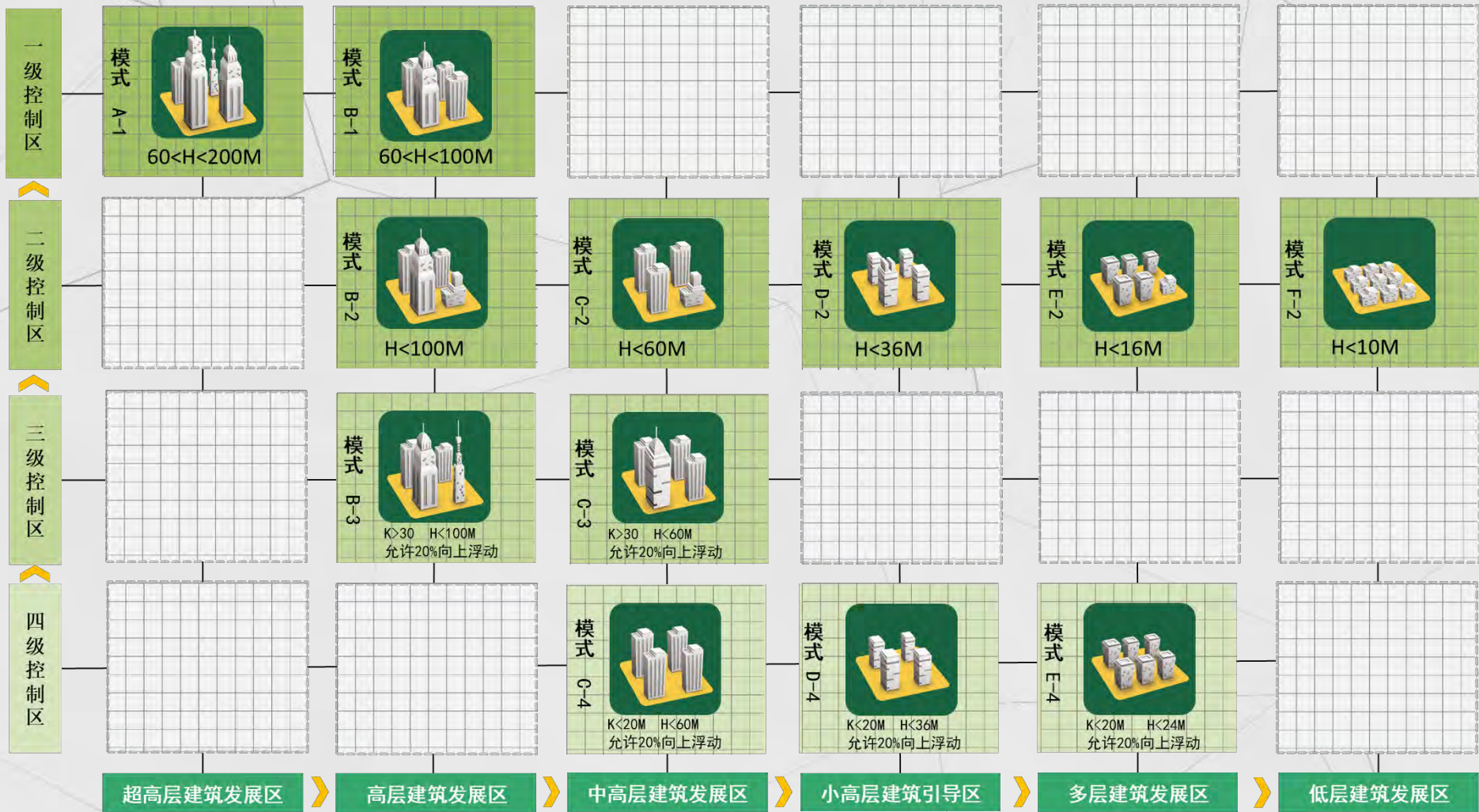
昆山城市高度控制矩阵（H表示地块建筑高度 K表示地块高度差）
