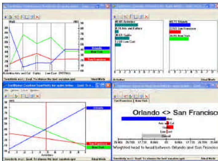
图 119 四种类型的敏感性分析图 (从左到右、从上到下依次为 Performance、Dynamic、Gradient、Head-to-head)
