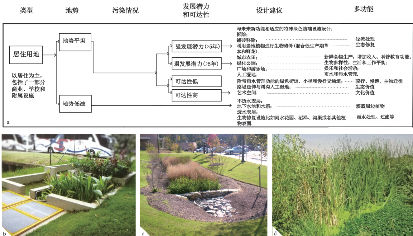
图1 居住用地绿色基础设施设计流程图(a.流程图, b.两个生物修复单元 [30] , c.雨水花园的雨水处理与渗透, d.包含莎草、香蒲、鸭茅和芦苇的具有混合植物的人工湿地 [31] )
