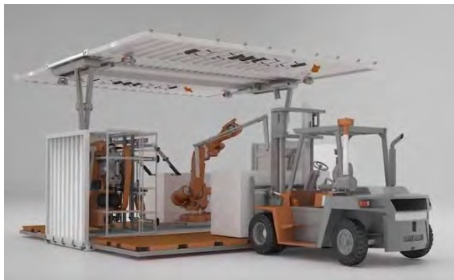
▲ 集成于集装箱内的机器人现场热切泡沫
