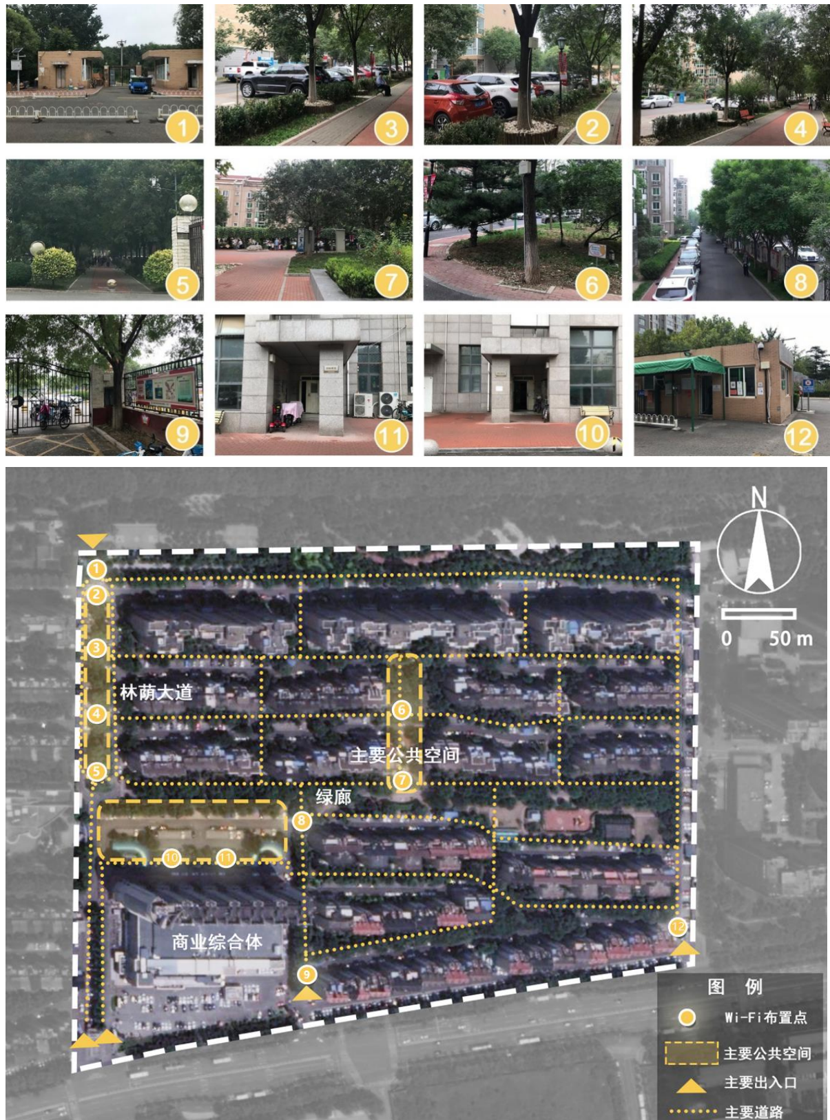
图 4-5 紫荆雅园 Wi-Fi 探针设备安装情况
